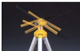
回転角度自在の回転グリップ (CPPS・PPS・MPPS II)
